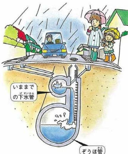
本市では、総合治水対策を進める上での「河川整備計画」に基づき10年確率(=概ね1時間50mm降雨)までの治水対策を行っています。これは、現状の下水管では流しきれない大雨時に、新たな巨大な下水管(=「雨水増補管」左図参照)で雨水を流す能力を増強させることや地下に大きなプール(=「雨水貯留施設」)をつくらせて雨水を貯めることにより浸水からまちを守る対策です。第二寝屋川より西の地域では、早くから下水道事
