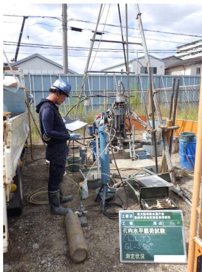
孔内水平載荷試験 試験状況 (GL-3.20~3.80m)
