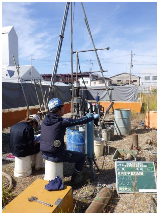
孔内水平載荷試験 試験状況 (GL-3.60~4.20m)
