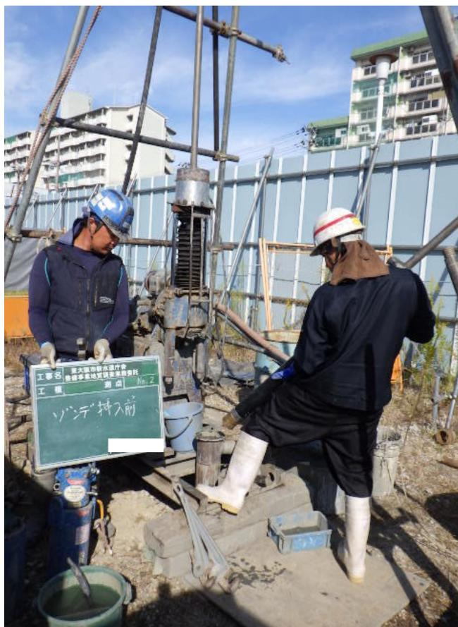
孔内水平載荷試験 ゾンデ挿入前 (GL-3.60~4.20m)
