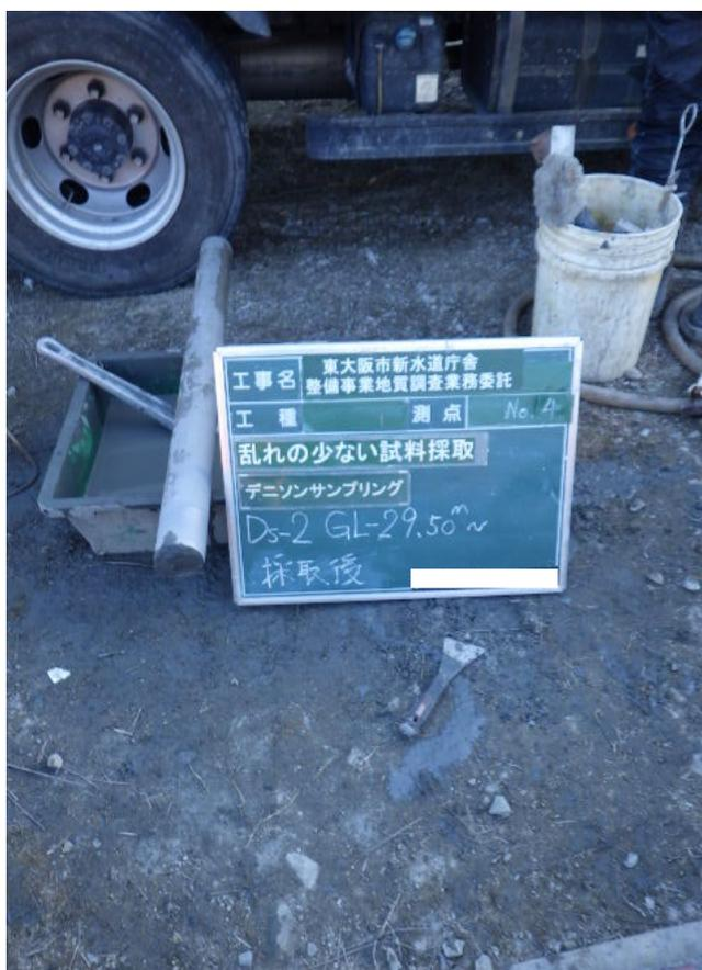
デニソンサンプリング 4D-1 (GL-29.50~31.20m) 採取後
