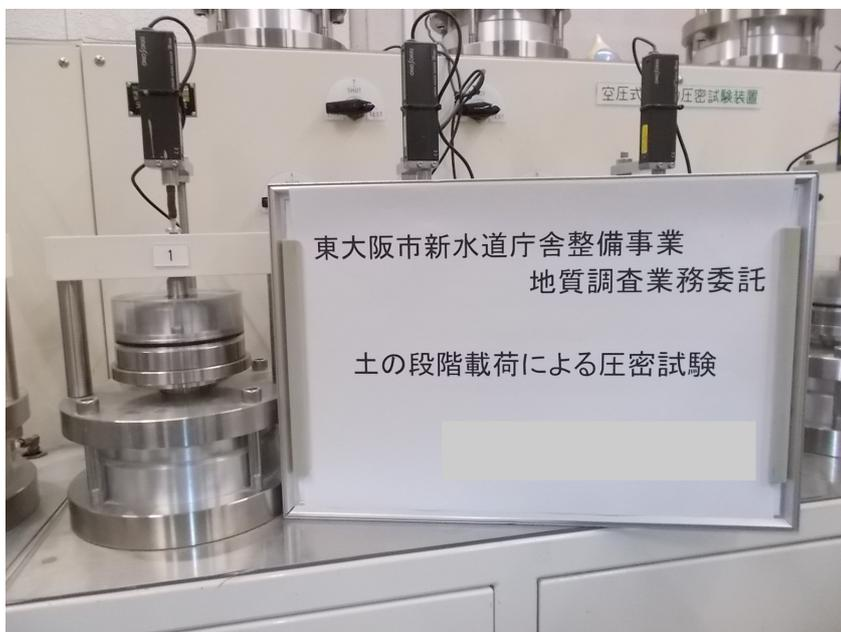
土の段階载荷による圧密試験
