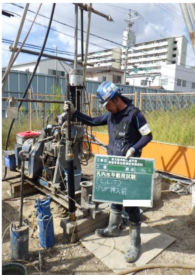
孔内水平載荷試験 ゾンデ挿入前 (GL-3.20~3.80m)
